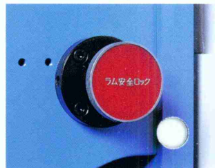
ラム安全ロック Ram locking mechanism
