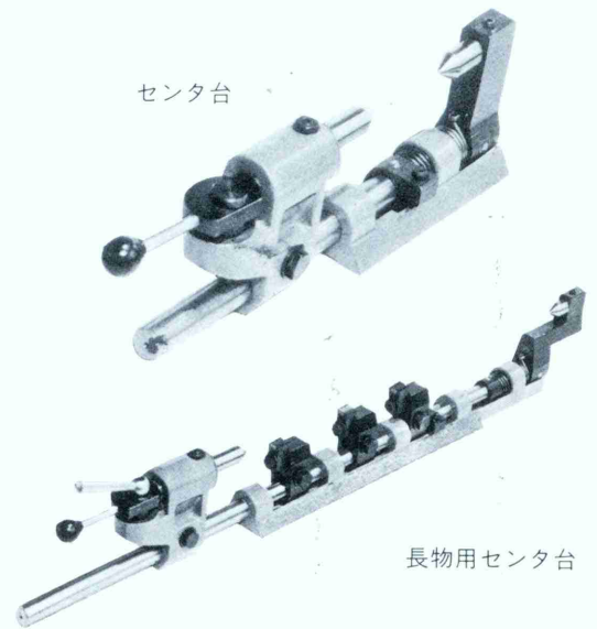
◀センタ台装置 (R15A) 2ロール補助軸受を使用
