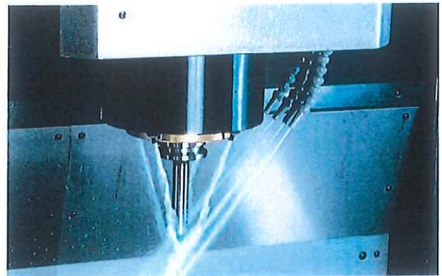
8本ノズルクーラント 吐出力 毎分 50 L 天井シャワークーラント 吐出力 毎分 100 L (特別仕様)
