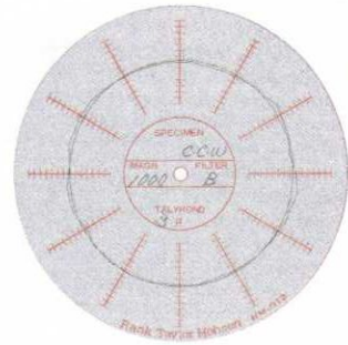
■真円切削 実測値: 3\mu\text{m} (スケールフィードバック無)
