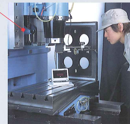
CMD装置によるYZ平面の真円精度測定
