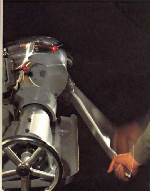
レバーによるモーターヘッドの揺動
