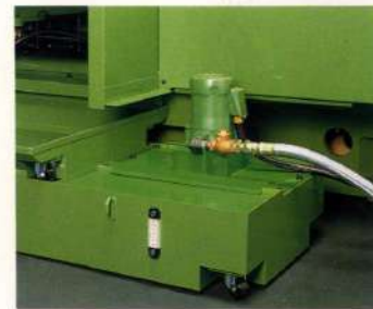
大容量のクーラントタンクを装備しています。MV-65/3001/MV-55/2501/MV-45/3004
