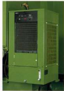
大型のオイルクーラを標準装備し、主軸頭のある発熱箇所へ冷却オイルを強制循環。主軸頭の熱変位を最小限に抑えます。
