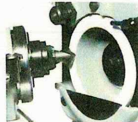
●スパイラルポイント 操作ハンドルを回しながら、自動的に両刃を交互に研削し、螺旋状の刃形が完成します。通常の刃研削とは別工程は不要です。
